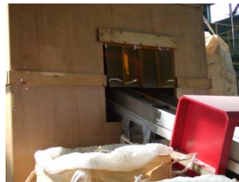
コンベアから金属探知後に投入し一時粉砕
